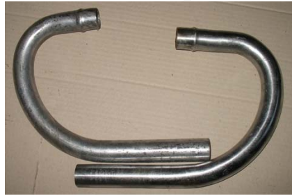
65012104-A + 65012107-A Exhaust Pipes, 35mm
