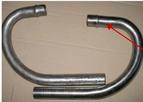
65012104-A + 65012107-A Exhaust Pipes, Chrome, 35mm
