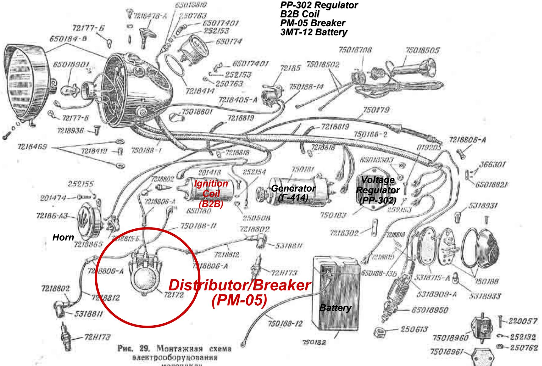
Рис. 29. Монтажная схема электрооборудования мотоцикла
