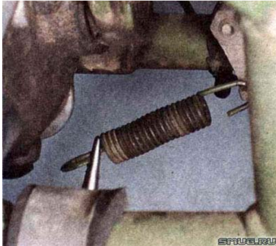
1. Remove pliers recoil brake pedal.
