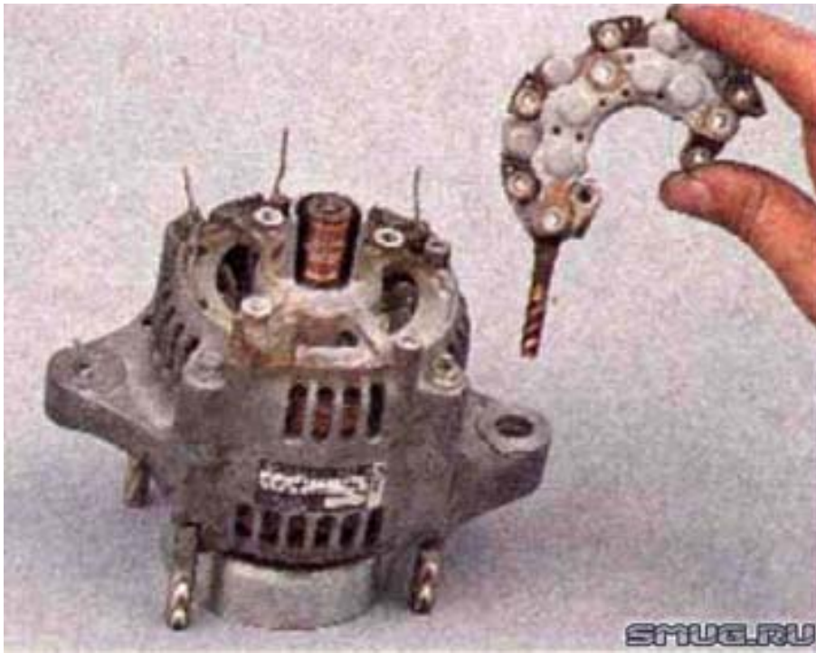
25. Remove the Rectifier Unit.
