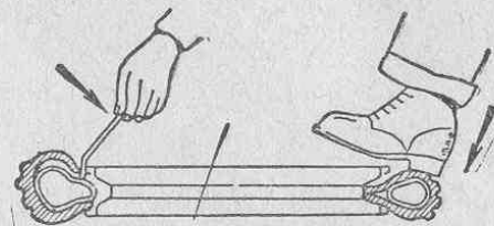
Рис. 81. Демонтаж шины колеса
